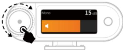
\*Setelah mengonfigurasi Pengaturan yang Direkomendasikan, jika level audio dinilai terlalu kencang atau terlalu pelan, sesuaikan penguatan output RX menggunakan kenop kontrol.
